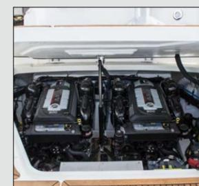
Das Testboot war mit zwei 6.2L 300 ECT von MerCruiser ausgerüstet. Die zwei V8-Motoren sind gleichzeitig die stärkste Motorisierung – und passen gut zum Boot. Ein «Downgrade» auf die schwächeren 4.5L 250 ECT macht angesichts der geringen Preisdifferenz eigentlich keinen Sinn. Möglich wäre dagegen eine Konfiguration mit zwei 3.0-260-TDI Dieselmotoren.
