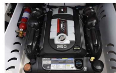
Das Testboot war mit einem rassigen 4,5 L V6-Motor von Mercruiser mit 250 PS, Katalysator und Alpha-One-Sterndrive ausgestattet. Als Option wäre auch ein 6,2 Liter Mercruiser Bravo III mit 300 PS für CHF 8300.– Aufpreis erhältlich, was jedoch die gute Fahrleistung im Spitzenbereich nur marginal steigert – ausser es befänden sich tatsächlich 13 Personen an Bord...
