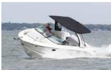
Die Sea Ray SLX 280 liegt gut im Wasser und ist dank einer ausgeprägten V-Form im Bug auch bei Wellengang ruhig und spurtreu unterwegs. Sie beschleunigt aus einem Guss, ohne dass der Bug angehoben wird. Vier Kimmkanten sorgen für zusätzlichen Auftrieb und angenehme Stabilität. Auch enge Kurven und schnelle Manöver meisterte die SLX 280 ohne Probleme.
