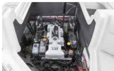
Das Testboot war mit einem MerCruiser 8.2 MAG mit 380 PS ausgestattet. Dieser kräftige V8-Motor sorgt für eine rassige Beschleunigung und eine Spitzengeschwindigkeit von gut 75 Stundenkilometern. Neu ist die Sea Ray SLX 280 auch mit dem 430 PS starken Big Block von MerCruiser erhältlich – der wird mit Sicherheit noch etwas mehr aus dem Boot «herauskitzeln».
