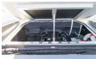
Das Testboot war mit einem Volvo Penta V8-Motor mit 350 PS ausgestattet – was sich als äusserst passende Motorisierung herausstellte. Die Marschfahrt liegt bei knapp 40 km/h (mit gut 3500 Touren), die Spitzengeschwindigkeit (mit 5750 Touren) bei über 70 km/h. Der elektrisch zu öffnende Motorraum ist übrigens bemerkenswert gut isoliert – auch das ein Qualitätsmerkmal.
